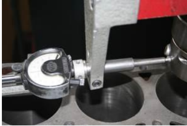
Resim 2.30: Sabit rektifiye tezgâhında manyetik komparatörün delme miline sıfırlanması
