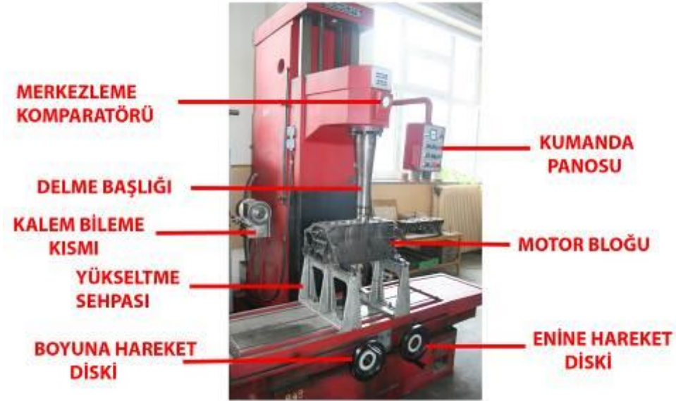
Resim 2.15: Sabit silindir rektifiye cihazının kısımları
