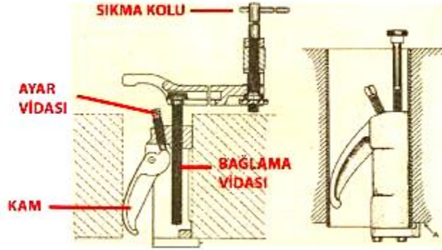
Şekil 2.14: Van Norman seyyar rektifiye cihazı bağlama düzeni
