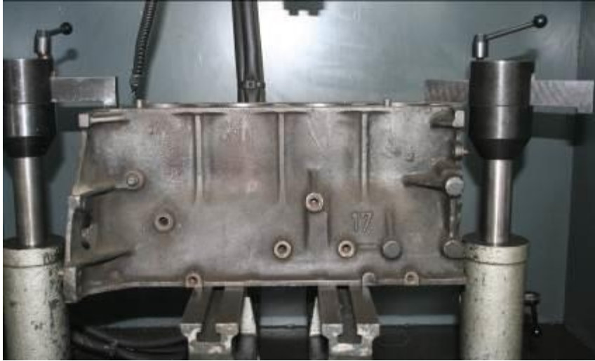
Resim 2.20: Bloğun sabit rektifiye cihazına üst kısımlarından bağlanması
