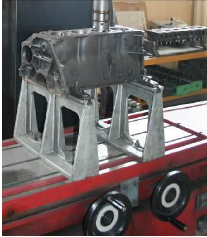
Resim 2.19: Bloğun sabit rektifiye cihazına yan kısımlarından bağlanması
