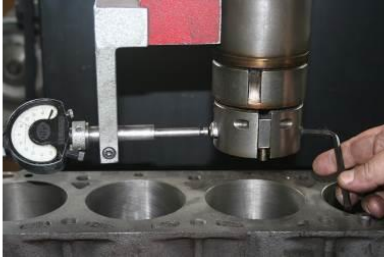
Resim 2.31: Sabit rektifiye tezgâhında kalem talaş ayarının yapılması
