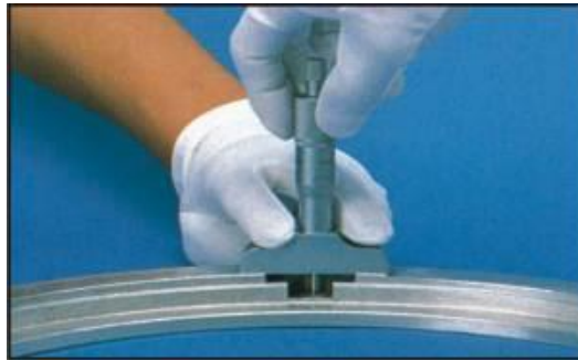
Resim 1.17: Derinlik mikrometresi ile ölçüm
