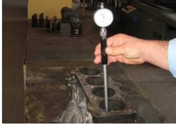
Resim 1.8: Komparatörle silindirden ölçü alınması
