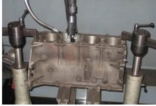
Resim 3.8: Bloğun honlama tezgâhına bağlanması ve merkezlenmesi
