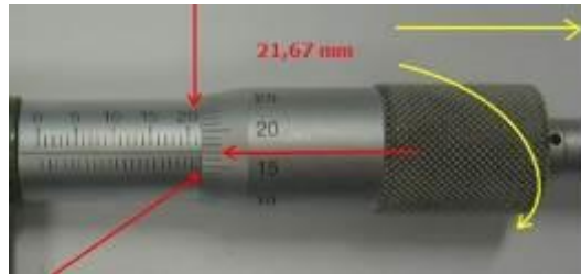
Resim 1.13: Mikrometre değeri 21,67 mm
