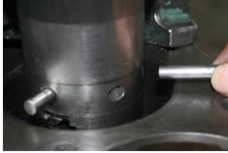
Resim 2.23: Merkezleme pimlerinin delme miline takılışı
