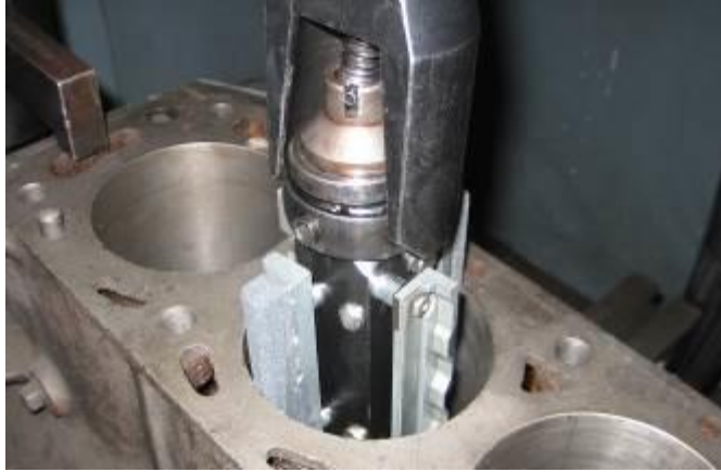
Resim 3.12: Başlığın silindire yerleştirilmesi
