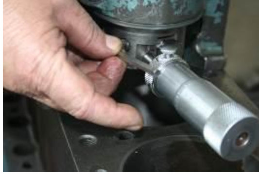
Resim 2.29: Delme mili üzerinde kalem talaş ayarının yapılması
