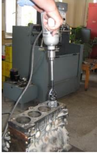
Resim 3.13: Breyiz ile honlama işleminde dikliğin sağlanması
