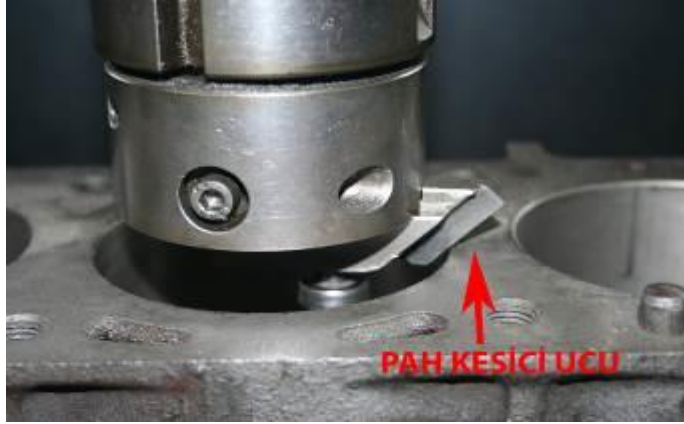
Resim 2.33: Silindirlere pah kırma işlemi
