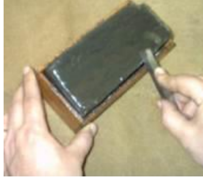
Resim 2.13: Kalemin kılađısının alınması
