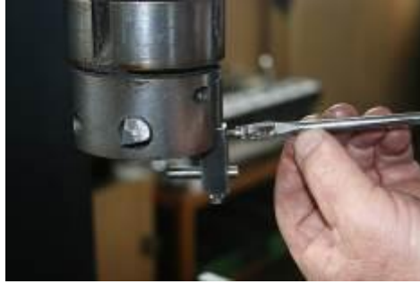
Resim 2.25: Merkezleme komparatör ayağının delme miline takılması
