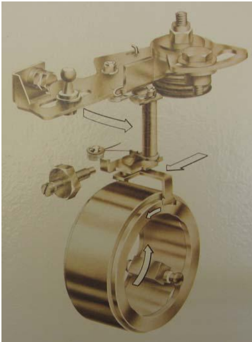
Şekil 3. 3: Yakıt ayar halkaları
