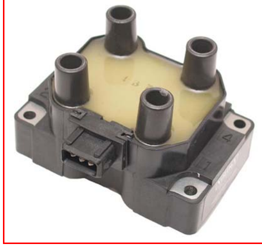
Resim 2.25: Distribütörsüz ateşleme sisteminde kullanılan ateşleme bobini
