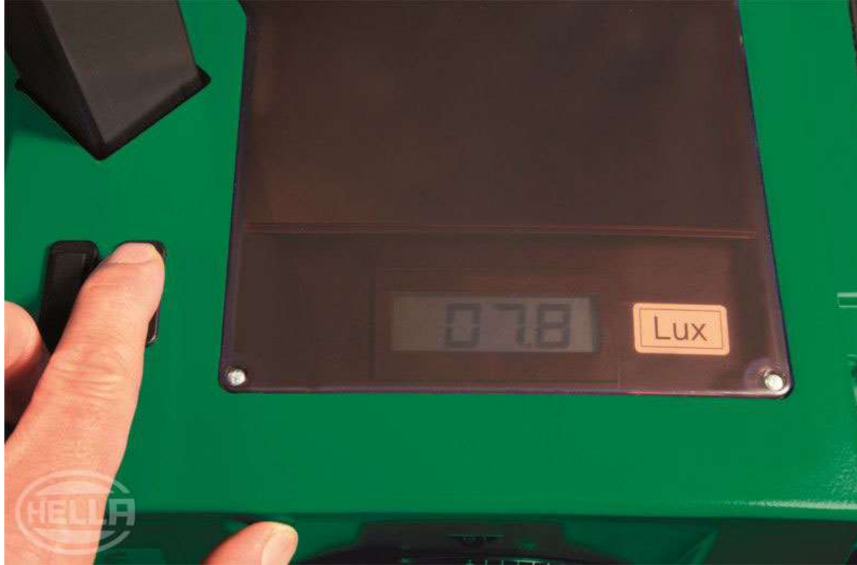
Şekil 10: Maks. Parlama değeri, halojen farda \leq 1,0 lüks, Xenon farda \leq 1,3 lüks
