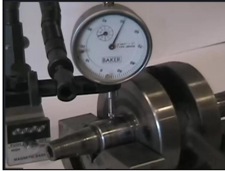
Şekil 3.7: Komparatörün kullanım örneđi
